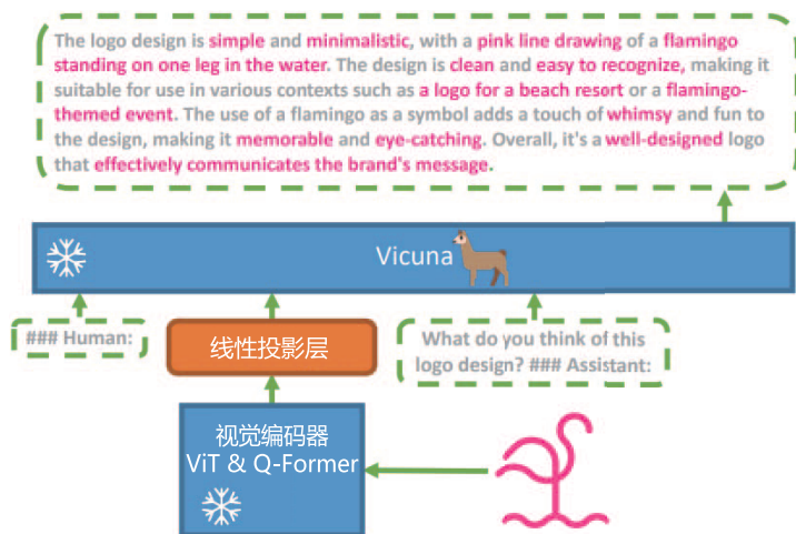
图 7.13 MiniGPT-4 的模型架构 [252]
